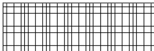
Fils d'acier galvanisé suivant EN 10244-2 - 50gr ZN/M<sup>2</sup>
